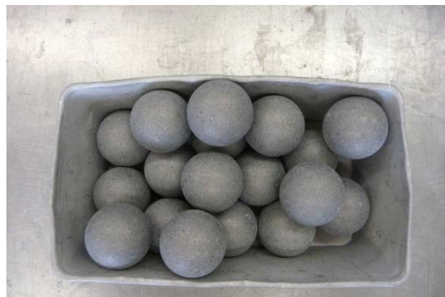
Figuur 2. Stalen ballen gebruikt voor de impact
